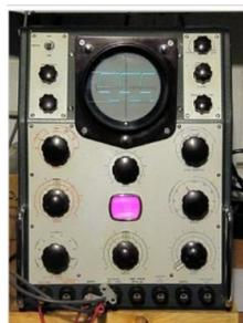
(4)早期的示波器体宽重沉,功耗巨大的原因来自于它的核心电路是基于电子管电路的。后来的HP公司和LeCroy公司相继提供了改进后的产品。1969年,HP公司的HP1980A型示波器问世,是一台全晶体管的示波器,频带宽度为500kHz。
