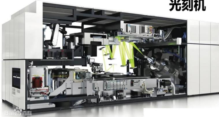
光刻机又叫掩模对准曝光机，是制造芯片的核心装备。它采用类似照片冲印的技术，把掩膜版上的精细图形通过光线的曝光印制到硅片上。芯片之母是光刻机。目前只有荷兰和日版能生产高端光刻机。中国自主的光刻机精度为 90nm。阿斯曼（ASML）公司已经拥有 5 nm 的加工精度。即使中芯国际采用先进技术，也是刚掌握 12nm 工艺、正在研发 10nm 工艺，而台积电 7nm 早已量产、正在开发 5nm 芯片制程工艺。
